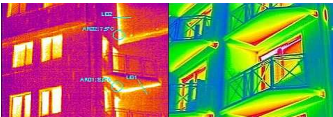
Mostki cieplne – płyta balkonowa
